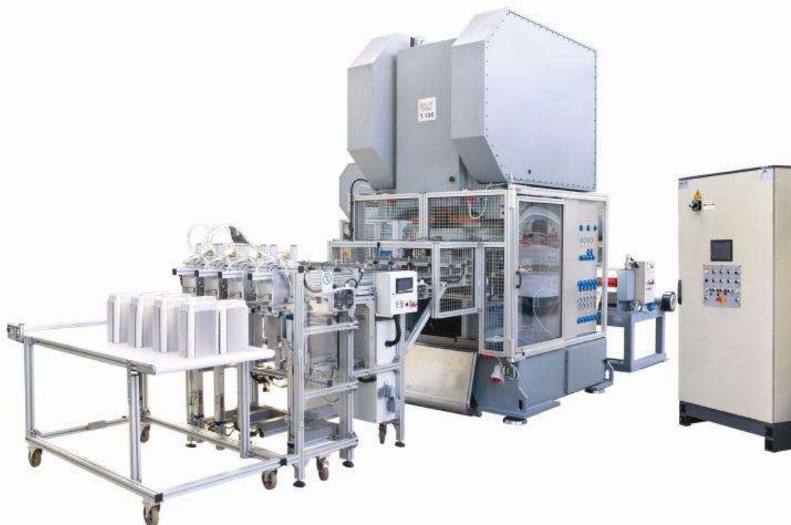
Fig. 21 – Immagine di una pressa con sistema di impilaggio automatico dei contenitori
