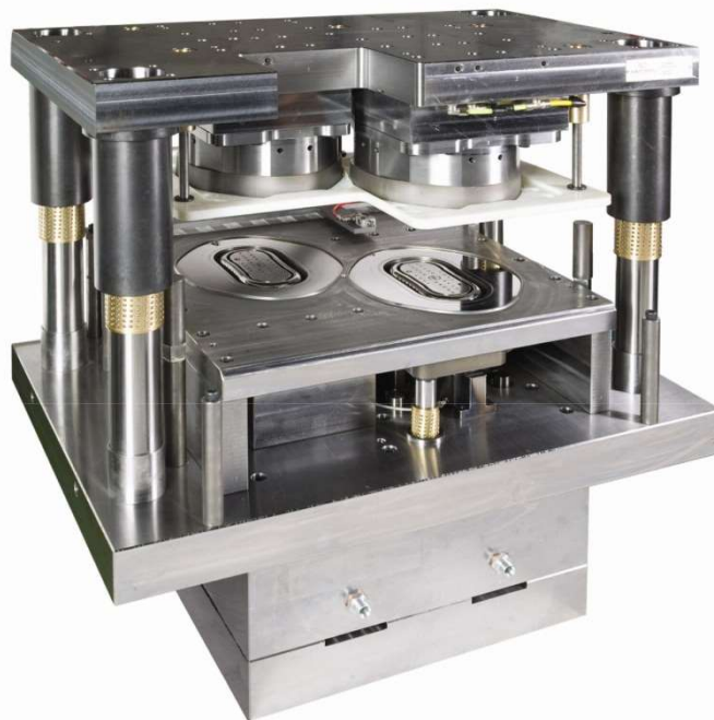
Fig. 19 – Esempio di stampo a due cavità per vaschette di alluminio
