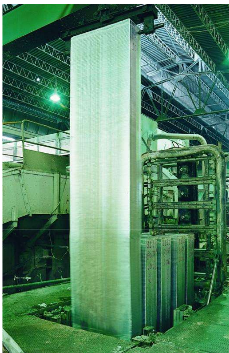
Fig. 8 – placche in estrazione dal pozzo di colata
