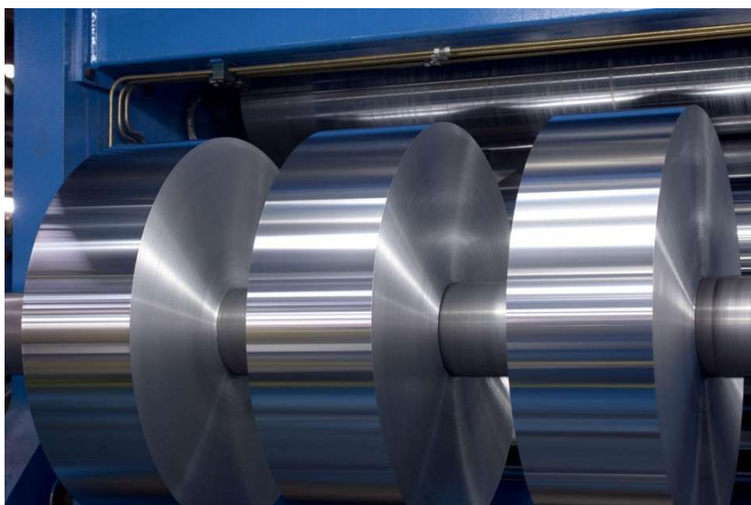
Fig. 13 – Operazione di taglio del coil in nastri opportunamente prelubrificati
