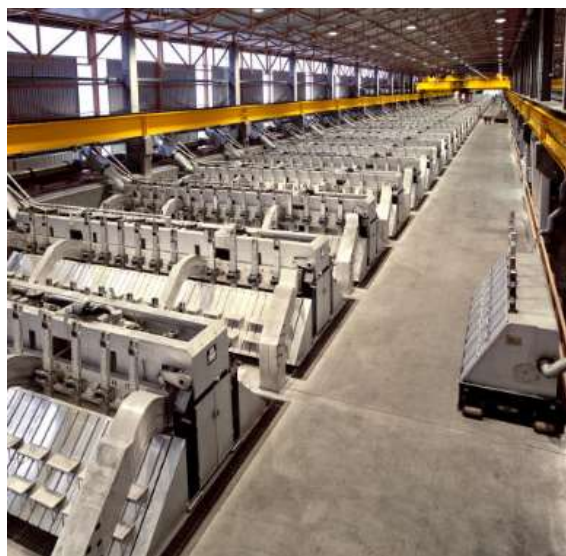
Fig. 5 - Foto da Norsk Hydro Aluminium - Suundal Smelter in Norvegia: produzione di alluminio primario per elettrolisi dell'allumina
