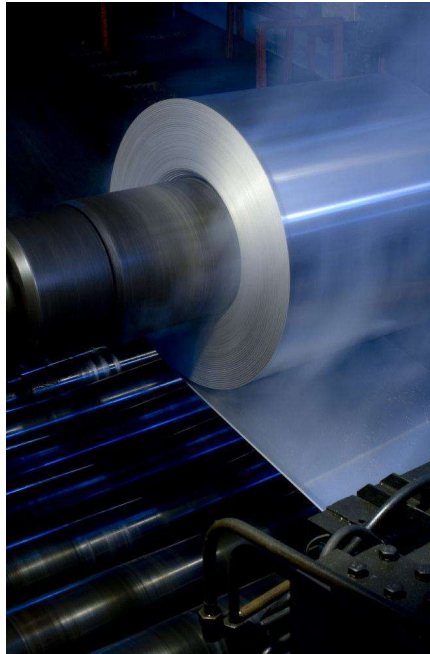
Fig. 11 – Avvolgitura del laminato a Caldo su aspo
